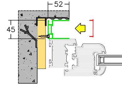
Incasto con profilo di chiusura e clip a falso telaio
