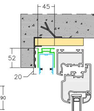
Zanzariera a scorrimento laterale con doppio cassonetto. Innovativa e priva di ogni barriera architettonica. Durante lo scorrimento può essere bloccata in qualsiasi punto della corsa, senza la necessità di accessori aggiuntivi. La nuova versione prevede il binario inferiore d'alluminio di soli 5 mm. Ideale per il transito di persone disabili e passeggeri.
