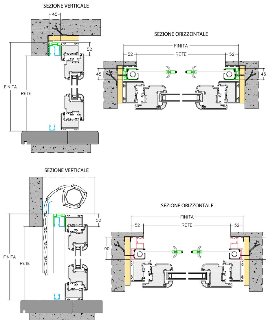
Incasso Lateral duplex Top Line è una zanzariera a molla, con doppio cassetto a scorrimento orizzontale, chiusura centrale e profilo multifunzione su 3 lati. Specifica per portefinestre, è dotata di anta semifissa con scroccetto standard a SX.
