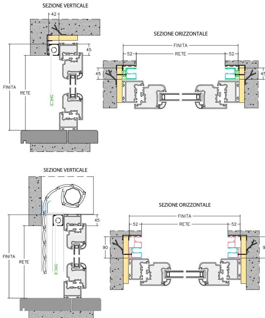
Incasso Vertical Top Line è una zanzariera a molla, da incasso, dotata di profilo multifunzione da posare sulle altezze. Esso funge sia da alloggiamento per la zanzariera da incasso, sia da tappo per la predisposizione. L'ingombro della zanzariera, inserita nel profilo multifunzione, sarà di totali 45 mm.
