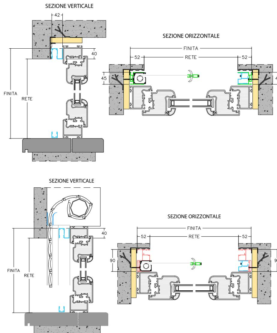
Incasso Lateral Top Line è una zanzariera a molla, da incasso laterale, dotata di profilo multifunzione sulle altezze. Esso funge sia da alloggiamento per la zanzariera da incasso, sia da tappo per la predisposizione. L'ingombro della zanzariera inserita nel profilo multifunzione sarà di totali 45 mm.
