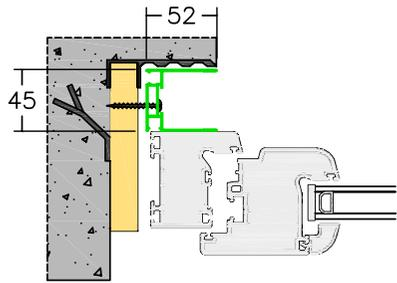
Incasto vite falso telaio
