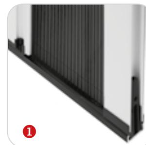
Sincro è una zanzariera ad impacchettamento orizzontale a doppio cassonetto con rete plissettata e comando frizionato. L'innovativo sistema di regolazione dei fili consente la movimentazione simultanea delle due ante agendo singolarmente su una di esse. Con ingombro massimo di 22 mm.
