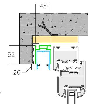
Incasso Ottika Top Line è una zanzariera da incasso, dotata di profilo multifunzione da posare sulle altezze. Esso funge sia da alloggiamento per la zanzariera da incasso, sia da tappo per la predisposizione. L'ingombro della zanzariera, inserita nel profilo multifunzione, sarà di totali 45 mm.
