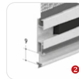
Zanzariera a scorrimento verticale, con meccanismo a molla. Adatta per finestre e con cassonetto di soli 31 mm di spessore. Realizzata con componenti di alta qualità, che garantiscono un funzionamento preciso e silenzioso. La scelta dell'utilizzo dei supporti a scatto (clips) permette una semplice installazione anche nelle situazioni più difficili.
