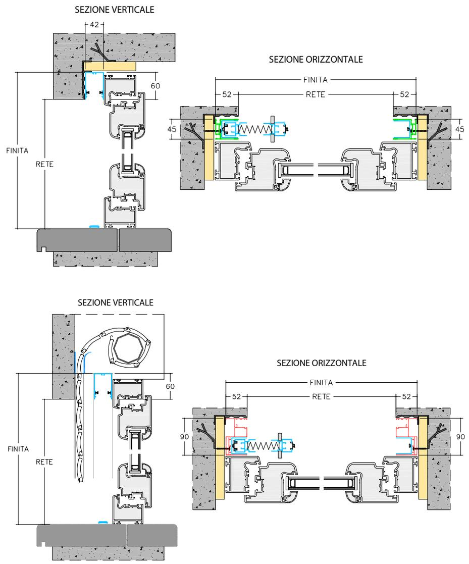
Plissé è una zanzariera per porte e finestre, realizzata con rete plissettata a riavvolgimento orizzontale. Comando frizionato. L'assenza di barriere a terra agevola il transito e le operazioni di pulizia. Ideale per il transito di persone disabili e passeggini.
