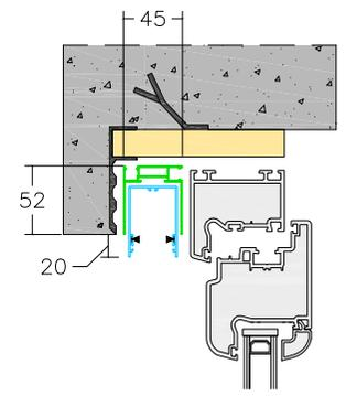
Incasso Ottika Duplex Top Line è una zanzariera da incasso, dotata di profilo multifunzione da posare sulle altezze. Esso funge sia da alloggiamento per la zanzariera da incasso, sia da tappo per la predisposizione. L'ingombro della zanzariera, inserita nel profilo multifunzione, sarà di totali 45 mm.
