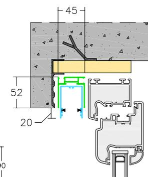
Zanzariera a scorrimento laterale. Innovativa e priva di ogni barriera architettonica. Durante lo scorrimento può essere bloccata in qualsiasi punto della corsa, senza la necessità di accessori aggiuntivi. La nuova versione prevede il binario inferiore d'alluminio di soli 5 mm e l'apertura reversibile. Ideale per il transito di persone disabili e passeggeri.
