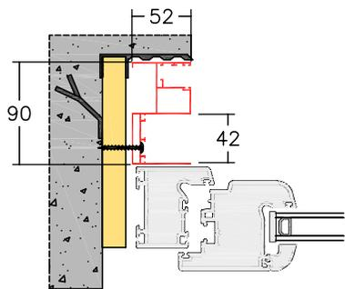
Incasto vite falso telaio
